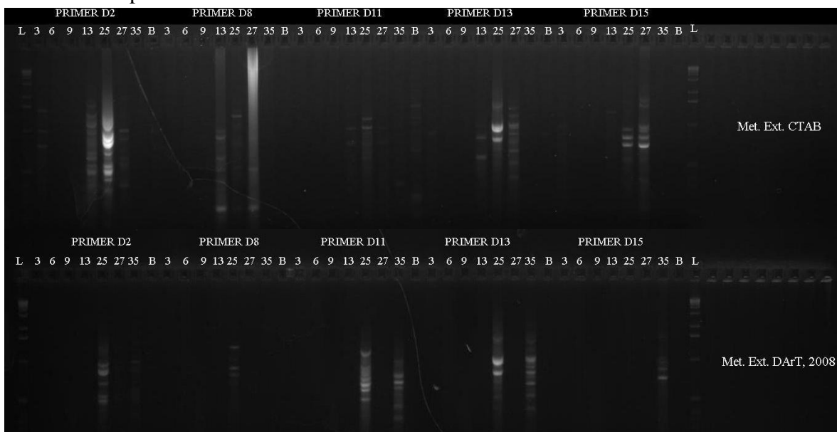
Legenda: Primers RAPD D2, D8, D11, D13, D15Operon, 2005; Amostras de DNA números: 3, 6, 9, 13, 25, 27, 35; B - reação sem material genético(Branco); L: Leadder1Kb; Gel de agarose 1,5%.
